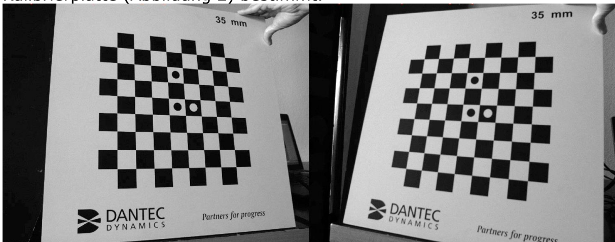
Abbildung 2: Stereoaufnahme einer Kalibrierplatte für die vollautomatische Systemkalibrierung.
